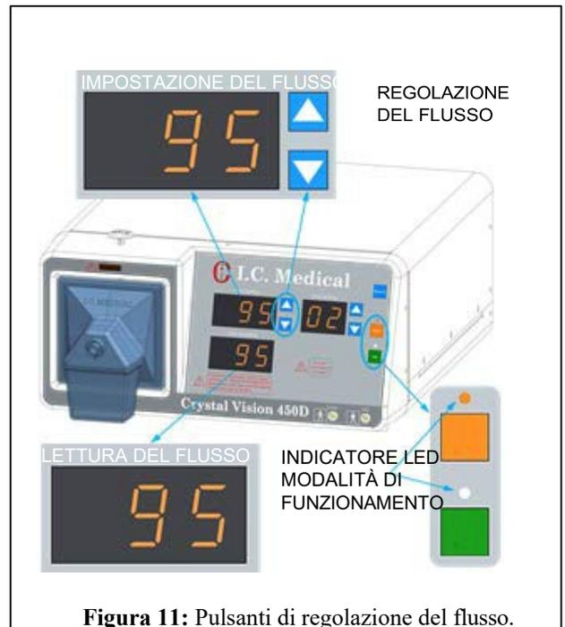
**Figura 11:** Pulsanti di regolazione del flusso.
